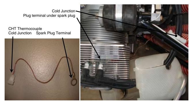
Figure 22. CHT Sender (Thermocouple) Installation
