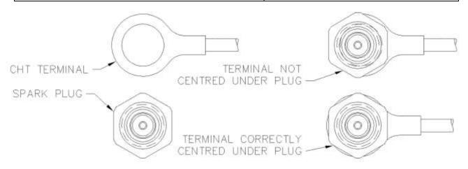
Figure 23. CHT Terminal Installation
